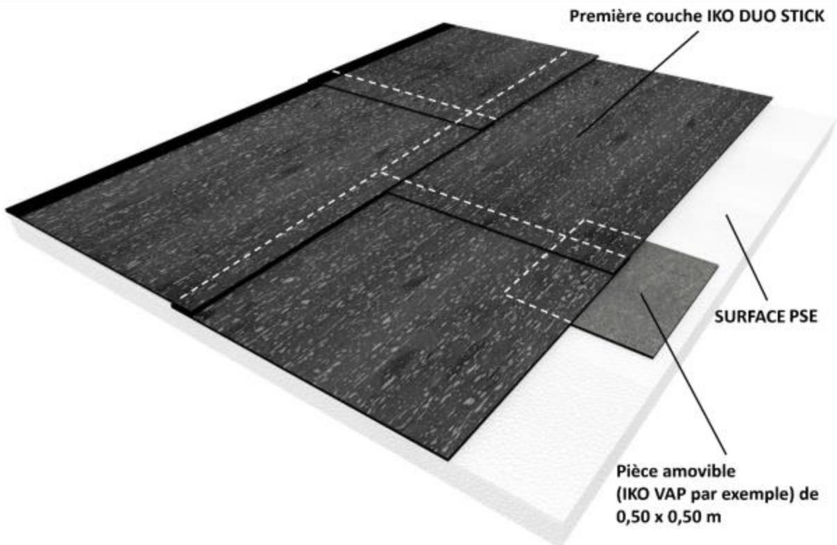
**Figure 2 - Protection des recouvrements transversaux de 20 cm pour les membranes IKO DUO STICK, et L4 JA F/MAT**
