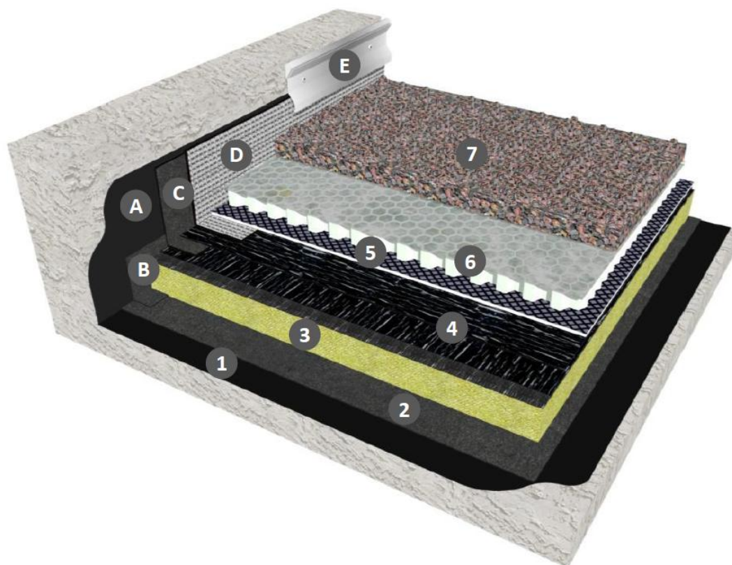
Figure 3 : Toiture-terrasse inaccessible avec protection par gravillons
