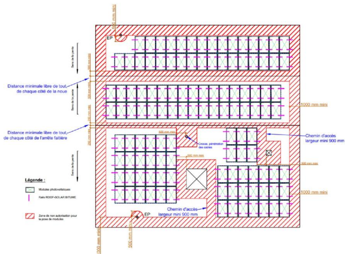
Figure 25 - Exemple de calepinage et de préparation de la toiture avec zones de modules
