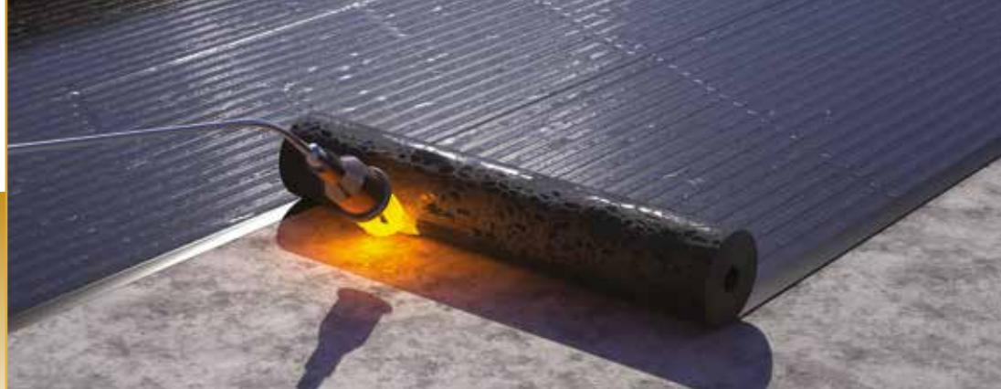
**IKO VAP ALPA 3 EN 1** est composé de liant ALPA, d'une armature en voile de verre, d'un film thermofusible en sous-face et de bandes semi-continues de bitume auto-adhésif protégées par un film thermofusible en surface.
