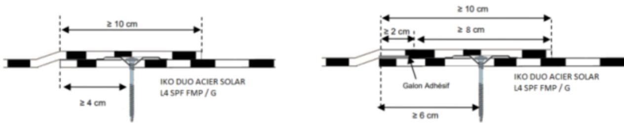
**Figure 5 – Recouvrements longitudinaux**
