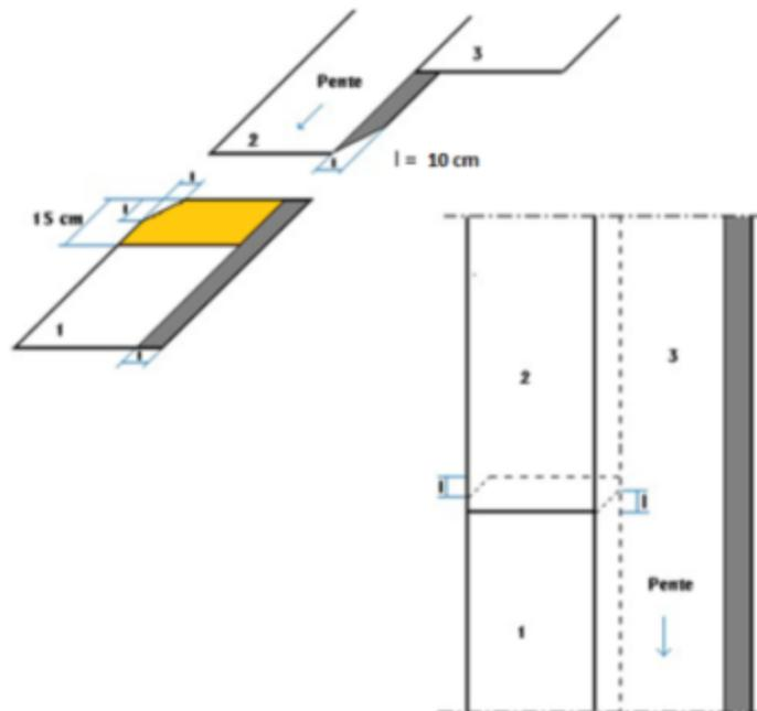
**Figure 6 - Déroulement des lés pour les monocouches**
